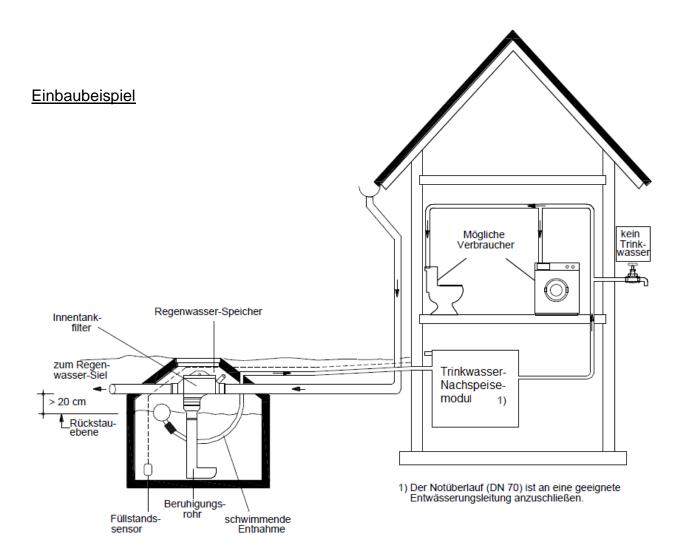
Auf eine strikte Trennung der Brauchwasser- und Trinkwasserleitungen (gem. DIN 1989-1) sowie auf eine konsequente Kennzeichnung von Leitungen und Zapfstellen muss unbedingt geachtet werden!
